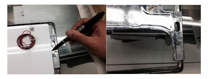
3.サンダー、音波カッター等で決めた位置の切り落としを行います。(※必ずフレームの淵の部分を残すようにして下さい。)
