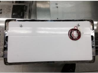
2.位置が決まったら、AIRの大きさに合わせて、ナンバーフレーム側にマジック等で切り落とす位置を決めます。
